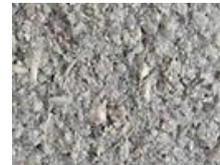
Bei längeren Trocknungszeiten können Salzkristalle an der Oberfläche auftreten. Diese sind vor der Weiterverarbeitung weg zu fegen.
